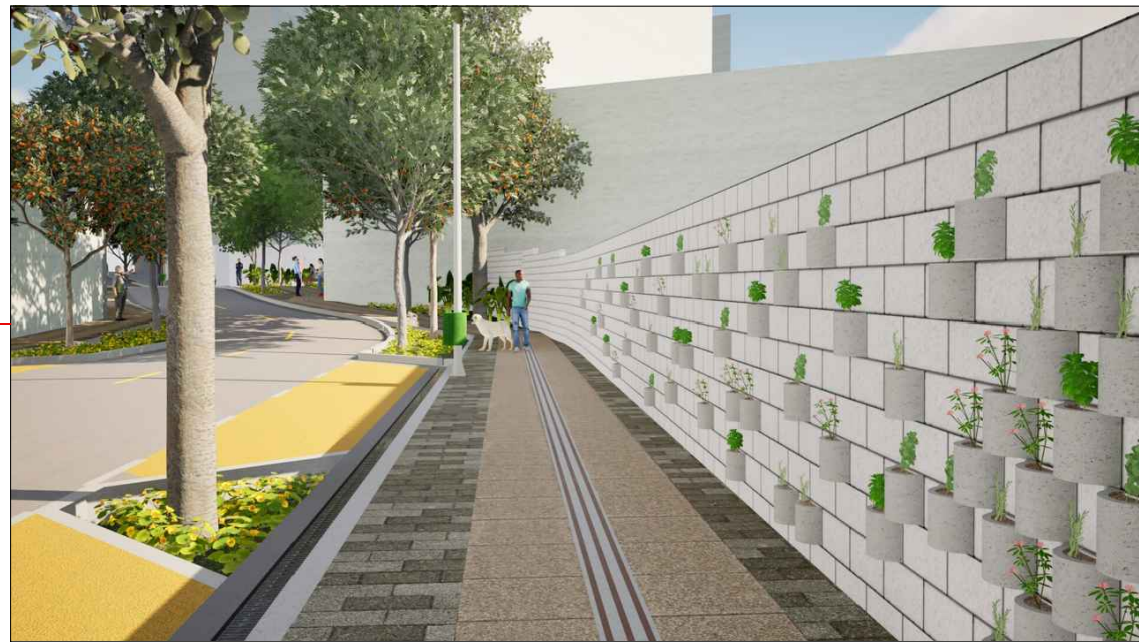
CALÇADA EM PLACA CIMENTÍCIA COM ACESSIBILIDADE
